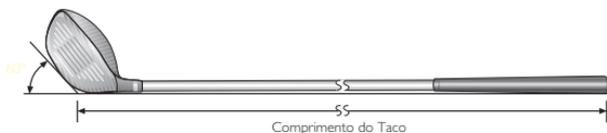
A medição do comprimento das madeiras e ferros é efectuada com o taco no plano horizontal, tendo a base encostada a um plano que faz com aquele um ângulo de  $60^\circ$ , conforme se indica na Fig. I. O comprimento é medido desde o topo da pega até ao ponto de interseção dos dois planos.
